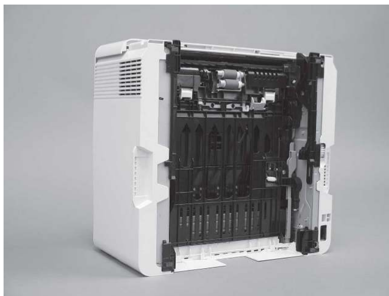
Rysunek 9-16 Umieść drukarkę spodem skierowanym do przodu
