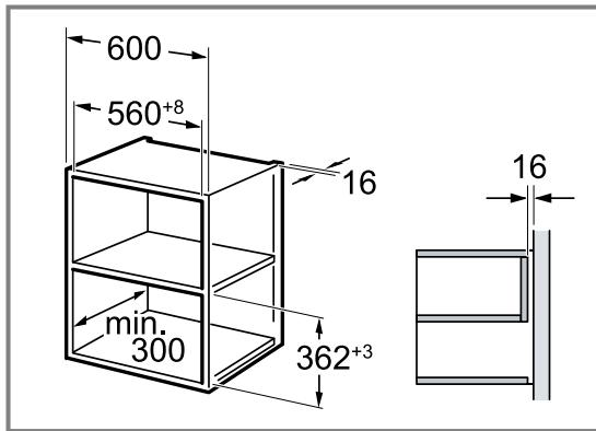
Urządzenie należy zamontować na takiej wysokości, aby możliwe było swobodne wyjmowanie wyposażenia. Usunąć nóżki.
