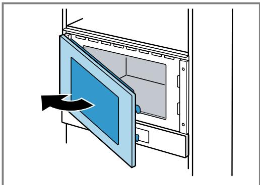
4. Przykręcić urządzenie do mebla po przeciwej stronie zawiasów.
